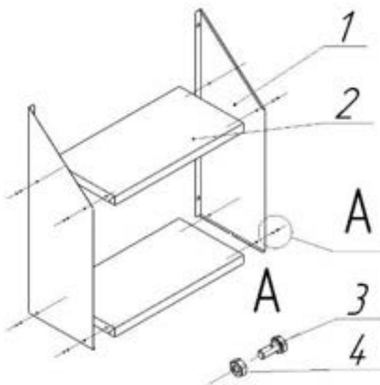
1. К полке (поз. 2) при помощи болта М6х12 (поз. 3) и гайки М6 (поз. 4) прикрепить боковые стенки (поз. 1);
