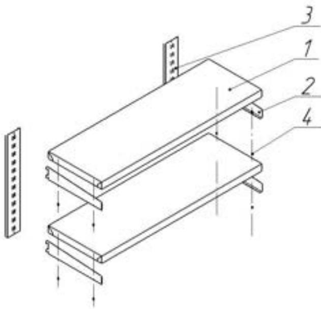
1. К полке (поз. 1) при помощи винтов (поз. 4) прикрепить боковые стенки (поз. 2);
