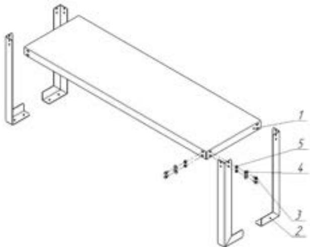
1. Установить полку (поз. 1) на стойках (наживить). Закрепить болтовыми соединениями (болт M6x12 (поз. 3), гайка M6 (поз. 4) и шайба M6 (поз. 5)).
