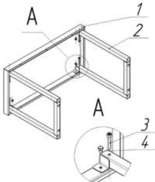
1. Прикрепить полку (поз. 1) к опорам (поз. 2) как указано на схеме сборки. Закрепить при помощи винтов M6\*35 (поз. 3) и болтов M6\*15 (поз. 4);
